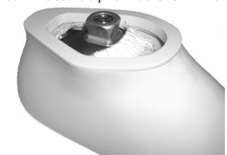
Sistemare la piastra di fissaggio nella cavità intorno all'apertura del cosmetico. Assicurarsi che la calza di rivestimento non rimanga impigliata durante l'assemblaggio con il raccordo piramidale femmina
